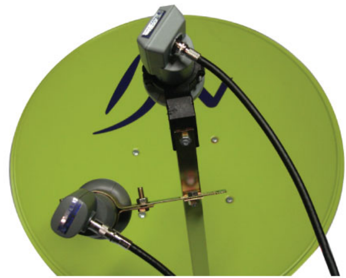
ต่อสายเข้ากับเครื่องรับสัญญาณ DTV แล้วดูสัญญาณ ให้แรงที่สุด โดยการสไลด์ซ้ายหรือขวา
